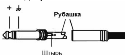
Разъем TS 1/4" Несимметричный вход/выход
