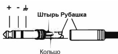
Разъем TRS 1/4" Симметричный вход/выход
